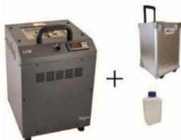
O banho portátil para calibração da Leyro, com uma profundidade de imersão de 190 mm e um diâmetro de 60 mm, permite uma gama de temperatura entre -30°C a 225°C.
